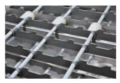
▲ 箱籃專用不鏽鋼輸送帶,能夠確保器具得到全面清洗及過水。大型煮食用具亦適用。
