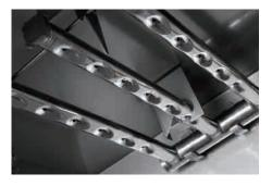
▲採用內凹式噴孔設計,防堵塞,加強清洗能力 和擴闊噴洗範圍。
