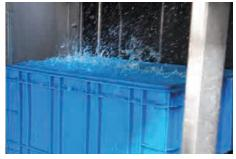
▲ 雙重風切系統為洗箱籃特製乾燥技術,先把濕 氣抽走,後進入上下高壓風切系統,容器上積水 瞬間噴走,使容器可快速投入生產使用。
